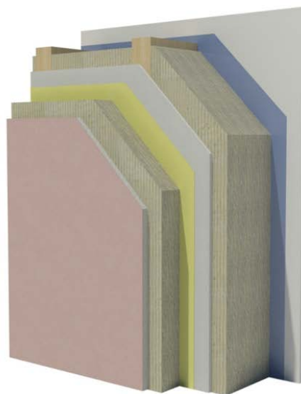
Figur B1. Exempel på schematisk uppbyggnad av materialskikt i ett av de studerade fasadsystemen, konstruktion 2.
